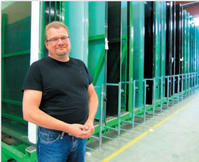
Tuomo Asumuksen takana olevat 18 m 2 :n lasilevyt painavat yksittäin 450 kg. Siirtämistä varten nosturi tarttuu levyyn imukupeilla.
